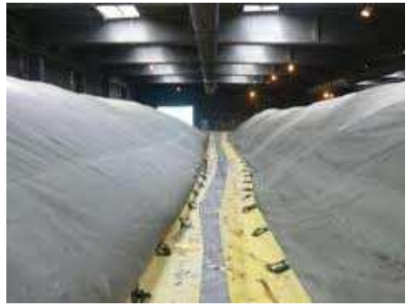
Fig. 13. Sezioni di un impianto TMB con biostabilizzazione del sottovaglio (contenente sostanza putrescibile)
